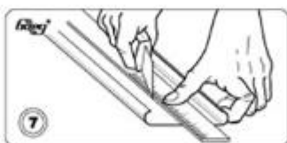
Разрезать панель вдоль по проведенной линии, неслучайно раз сильно провести ножом по месту реза.
