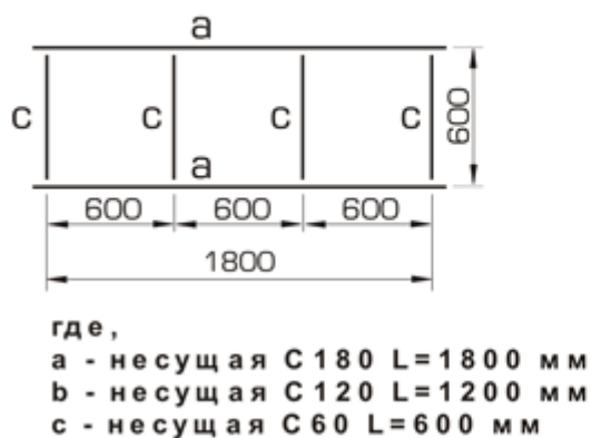
Схема сборки потолка ГРИЛЬЯТО для решеток с ячейкой < 75x75 мм
